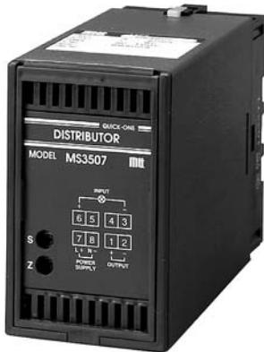
MS3507 2線式伝送器変換器(ディストリビュータ)は、2線式伝送器(出力信号:4~20mA)に対して電源を供給し、その伝送信号をDC出力信号に変換する製品です。
