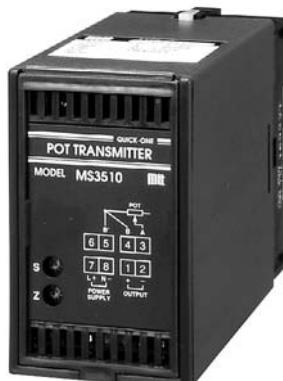
MS3510 ポテンショメータ信号変換器は、すべり抵抗変化を出力とするセンサに対して定電流を供給し、そのmV入力信号を増幅して、DC出力信号に変換する製品です。
