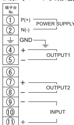
2線式センサ供給電源付の配線はセンサの種類により接続が異なる場合があります。
