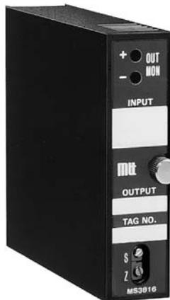
MS3816 一次遅れ変換モジュールは、ハイレベルDC入力信号に対して0.2~20sec.まで可変できる一次遅れ時定数で応答し、DC出力信号に変換する製品です。
