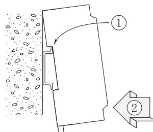
製品についているレールホルダを下にして、その反対方向にあるツメをレールに引っ掛けてから製品を図のように嵌め込み、レールホルダをかけて固定します。
