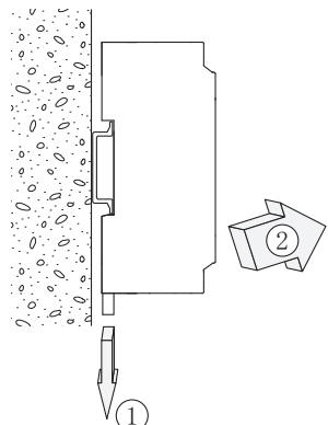
製品下部のレールホルダの溝にマイナスドライバー等を押しこみ、それを下方に押しながら製品の下部を手前に引きます。
