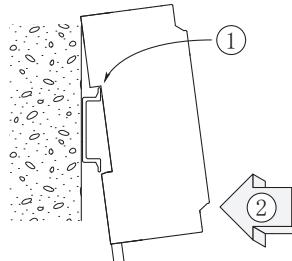
製品についているレールホルダを下にして、その反対方向にあるツメをレールに引っ掛けながら製品を図のように嵌め込み、レールホルダをかけて固定します。
