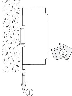
製品下部のレールホルダの溝にマイナスドライバ等を押し込み、それを下方に押しながら製品の下部を手前に引きます。
