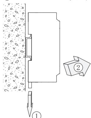
製品下部のレールホルダの溝にマイナスドライバ等を押し込み、それを下方に押しながら製品の下部を手前に引きます。
