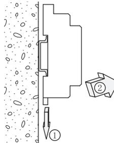
ソケット下部のレールホルダの溝にマイナスドライバ等を押込み、それを下方に押しながらソケットの下部を手前に引きます。
