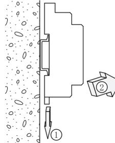
ソケット下部のレールホルダの溝にマイナスドライバ等押し込み、それを下方に押しながらソケットの下部を手前に引きます。
