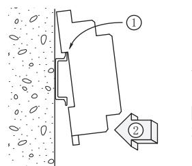
ソケット基板についているレールホルダを下にして、その反対方向にあるツメをレールに引っ掛けてからソケットを図のように嵌め込み、レールホルダをかけて固定します。
