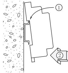
ソケット基板についているレールホルダを下にして、その反対方向にあるツメをレールに引っ掛けたからソケットを図のように嵌込み、レールホルダをかけて固定します。
