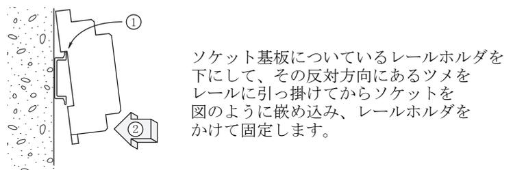
ソケット基板についているレールホルダを下にして、その反対方向にあるツメをレールに引っ掛けてからソケットを図のように嵌め込み、レールホルダをかけて固定します。
