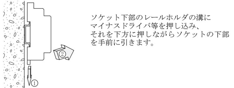
ソケット下部のレールホルダの溝にマイナスドライバー等を押し込み、それを下方に押しながらソケットの下部を手前に引きます。
