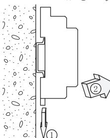
ソケット下部のレールホルダの溝にマイナスドライバ等を押し込み、それを下方に押しながらソケットの下部を手前に引きます。
