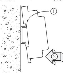
ソケット基板についているレールホルダを下にして、その反対方向にあるツメをレールに引っ掛けてからソケットを図のように嵌め込み、レールホルダをかけて固定します。
