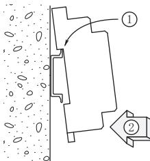
ソケット基板についているレールホルダを下にして、その反対方向にあるツメをレールに引っ掛けながらソケットを図のように嵌め込み、レールホルダをかけて固定します。
