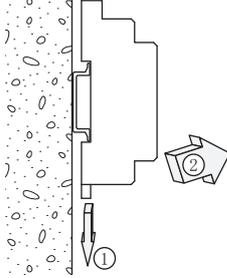
ソケット下部のレールホルダの溝にマイナスドライバ等押し込み、それを下方に押しながらソケットの下部を手前に引きまします。
