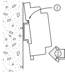
ソケット基板についているレールホルダを下にして、その反対方向にあるツメをレールに引っ掛けてからソケットを図のように嵌め込み、レールホルダをかけて固定します。
