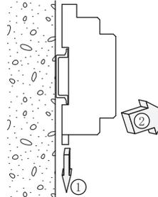
ソケット下部のレールホルダの溝にマイナスドライバ等を入れ込み、それを下方に押しながらソケットの下部を手前に引きます。
