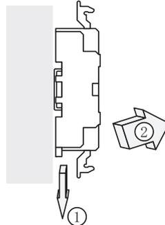
ソケット下部のレールホルダの溝にマイナス・ドライバ等を挿し込み、それを下方に押しながらソケットの下部を手前に引きます。
