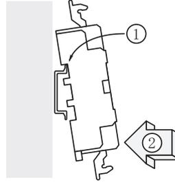
ソケット基盤についているレールホルダ（黄色の部分）を下にして、その反対方向にあるツメをレールに引っ掛けてからソケットを図のように嵌め込み、レールホルダをかけて固定します。
