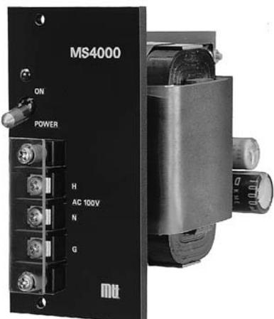
PS4000 AC電源ユニットは、商用AC電源を入力とし、MS4000シリーズ信号変換器に必要な24V DC電源を出力する製品です。PS4000は、MS4000シリーズ信号変換器同様、変換器収納ラックケース (RC4000) の右端のスロットに取り付けて使用します。前面パネル上の端子台からAC電源を入力すると、ラックケース内のバックプレーンを通じて信号変換器に24V DC電源が供給されます。
